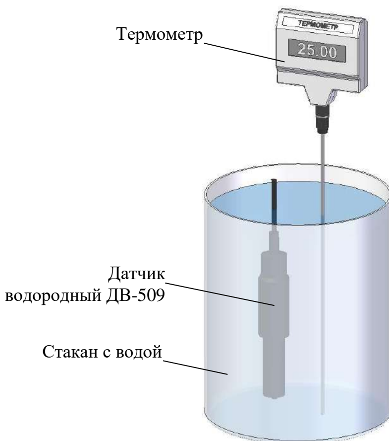
Рисунок 3.2 – Проверка показаний по температуре
