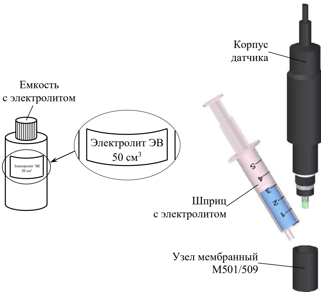
Рисунок 2.7 – Заливка (добавление) электролита
